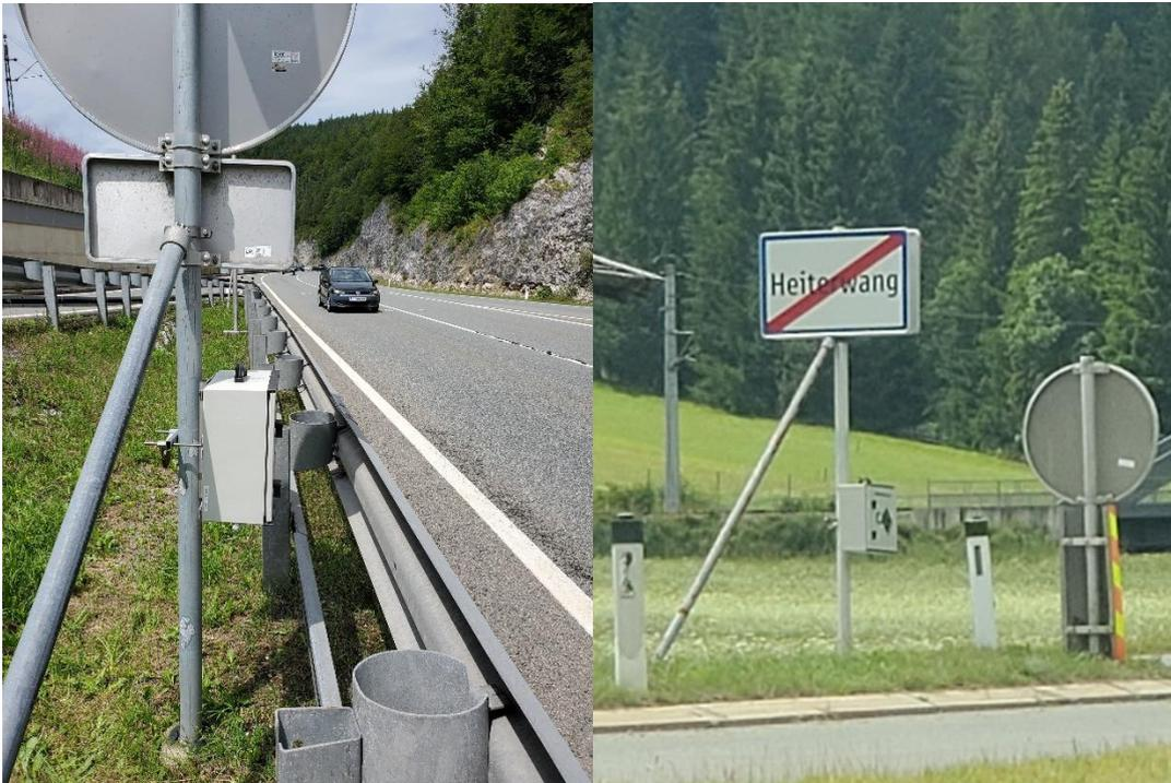
Abbildung 2-4: eigene Zählstellen mit Seitenradar in Heiterwang
