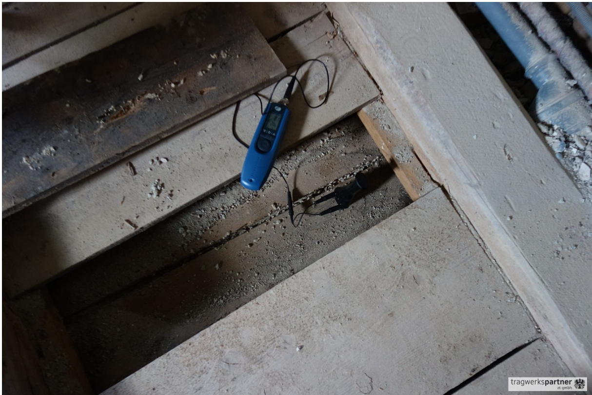
Abbildung 5: Holzfeuchtemessung im (geöffneten) Fußbodenaufbau in „Feldmitte“
